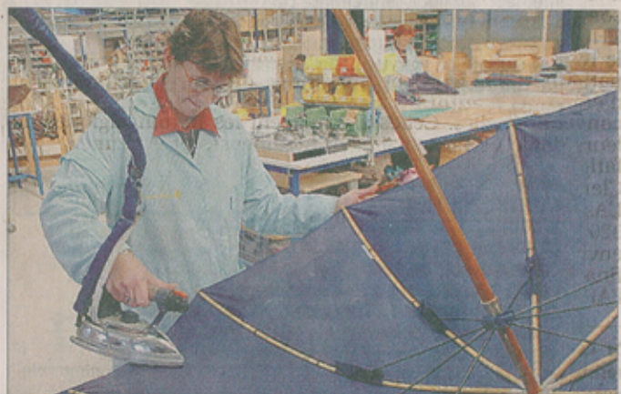
TRADITION. L'entreprise fabrique encore des parapluies de berger, reconnaissables à leurs baleines en rotin.
